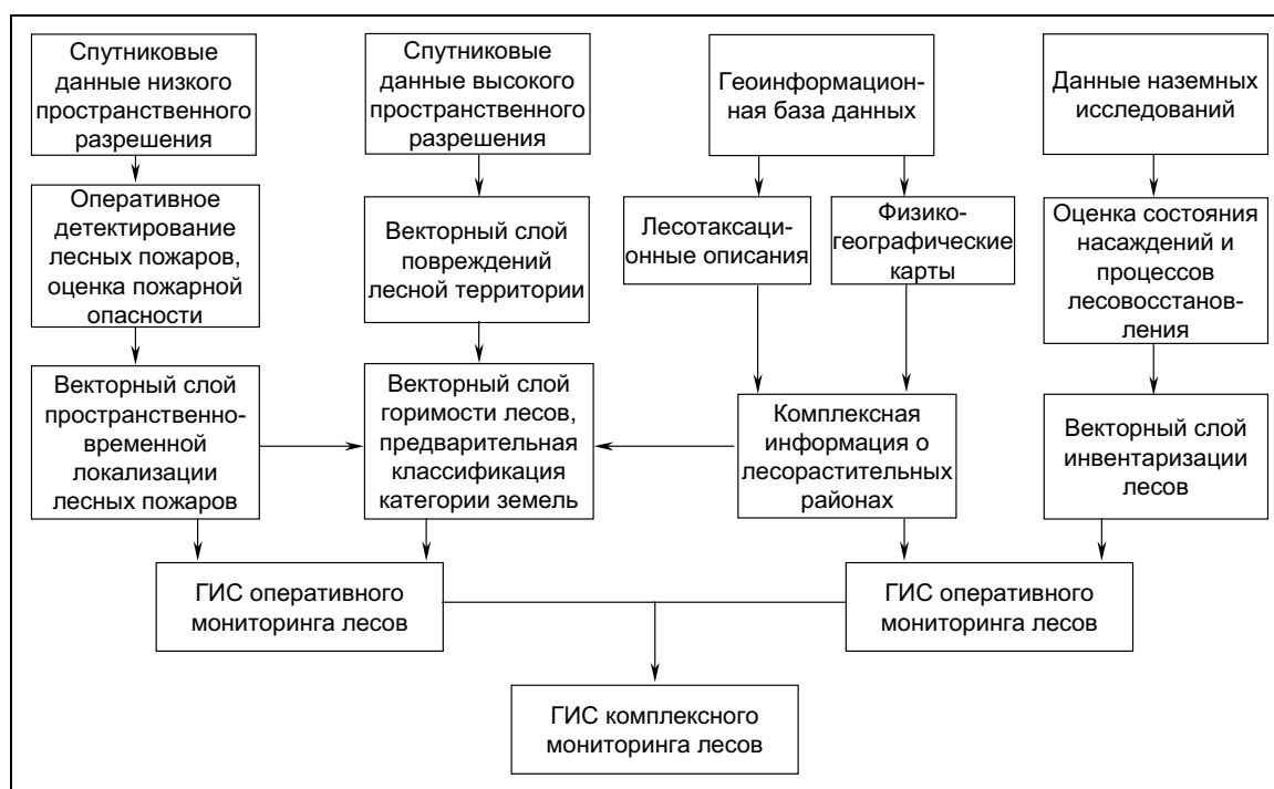
Рисунок 1 – Общая схема ГИС для комплексного мониторинга лесов с использованием данных наземных и дистанционных исследований
